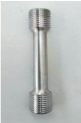
图 5 低周疲劳试验样件
