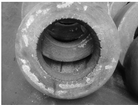
图 1 环形件轧制开裂形貌
