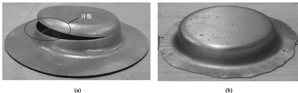
图 10 室温和超低温下 2219-O 铝合金薄板成形实验
