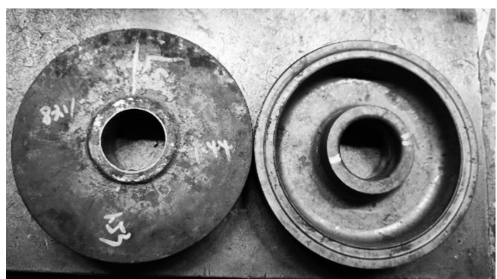
图11 深轮辐齿坯件锻件图
