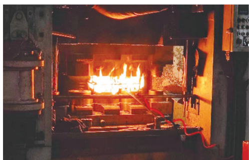
图10 深轮辐齿坯件多工位闭式热精锻成形试验
