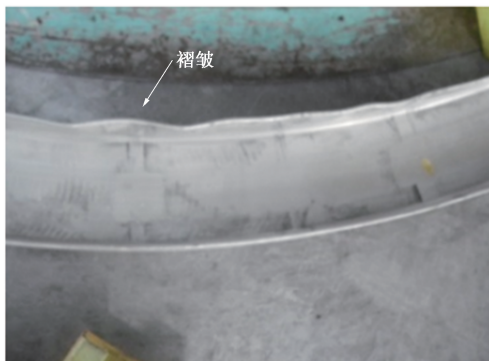
图 2 零件褶皱图 Fig. 2 Wrinkle drawing of part
