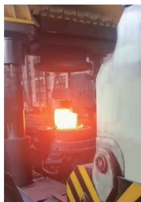
图4 坯料镦粗结束时的状态
