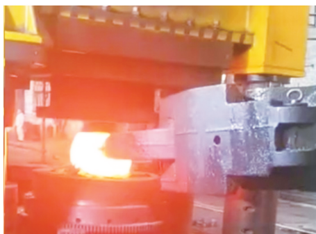
图 6 坯料冲孔现场图 Fig. 6 On-site photo of blank punching
