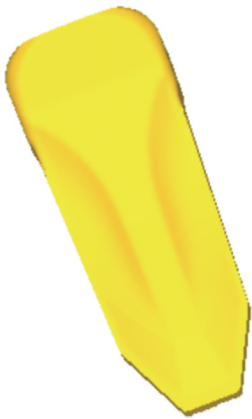
图 17 数值模拟得到的预锻件 Fig. 17 Pre-forgings obtained from numerical simulation
