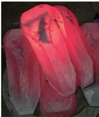
图 16 工艺实验得到的预锻件 Fig. 16 Pre-forgings obtained from process test
