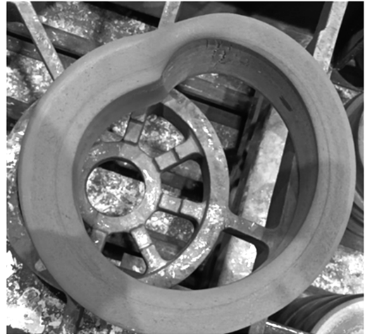
图5 初始轧制阶段环增速过大导致的缺陷
