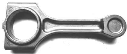
图 9 TC4 钛合金连杆锻造毛坯
