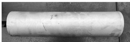
图 8 退火后旋压成形的内径为 \Phi 112 mm 的薄壁管
