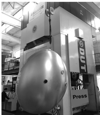
图11 直径为 \Phi 2.25 m 的 2219 铝合金整体箱底
