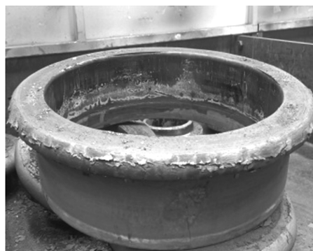
图 13 DN700 大规格凸缘成形件
