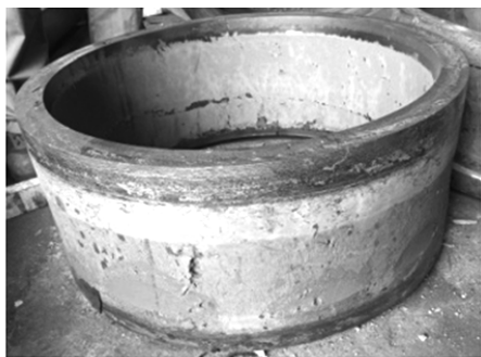
图 12 改进工艺下 DN700 大规格凸缘环件示意图
