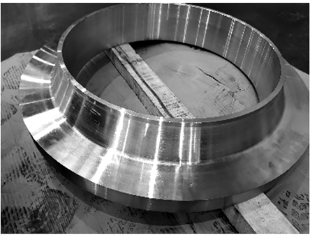
图 18 高颈法兰机加工成品 Fig. 18 Machined product of high neck flange
