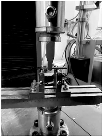
图 4 三点弯曲试验
