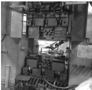
图 8 夹模机构在锻造自动化生产线上的应用
