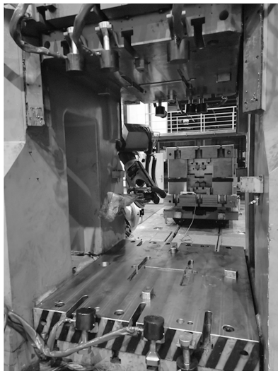
图 9 快速换模装置在锻造自动化生产线上的应用
