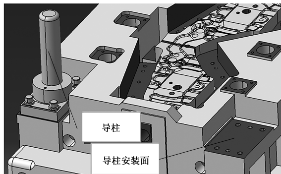
图 15 上模本体导柱的安装 Fig. 15 Installation of guide post for upper die body
