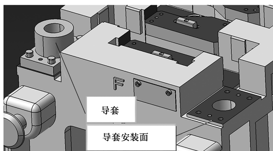
图 14 下模本体导套的安装 Fig. 14 Installation of guide sleeve for lower die body
