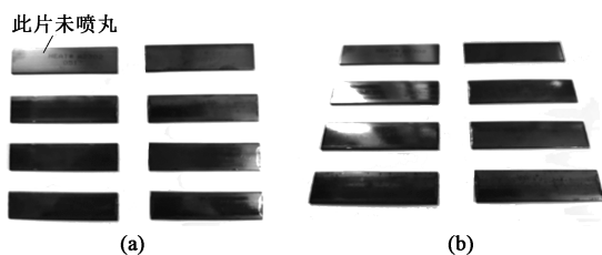
图 5 超声波喷丸后的 Almen 试片 (a) 形貌对比 (b) 弧高对比
