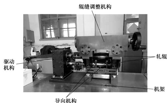
图 1 基于刚性弧形辊的三维曲面柔性轧制装置
