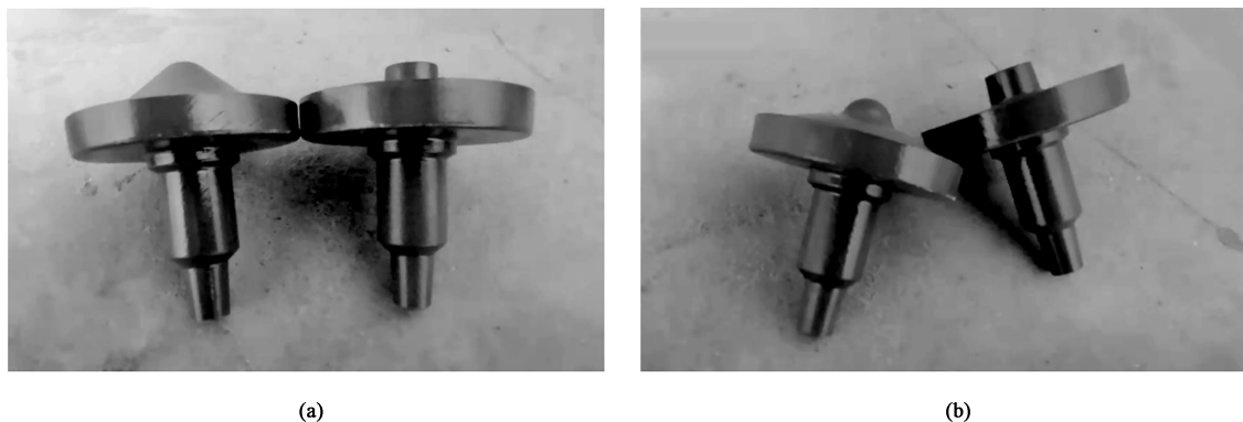
图 10 改进后两种方案的锻件试验结果
