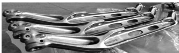
图 3 国外 7101 轻量化前轴 Fig. 3 Foreign-made 7101 light-weight front axle
