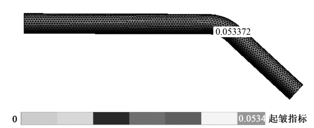
图 6 起皱准则评价结果 Fig. 6 Evaluation result of wrinkling criterion
