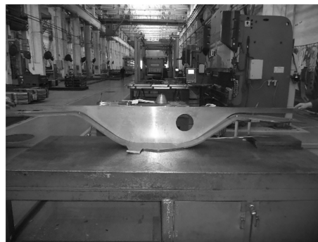
图7 侧梁上盖板实验件轮廓测量
