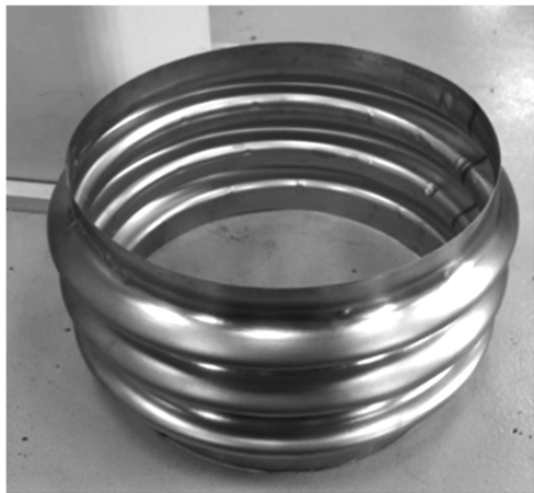
图 5 最优工艺参数组合下加工的波纹管实物图
