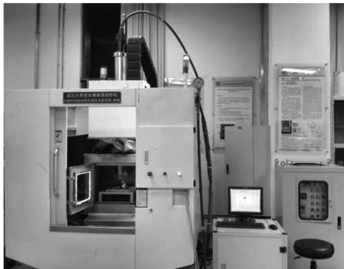
图3 数控五轴高压水射流渐进成形机床实物图
