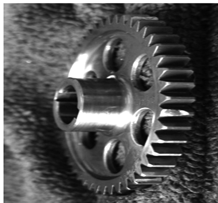
图 1 故障齿轮宏观形貌
