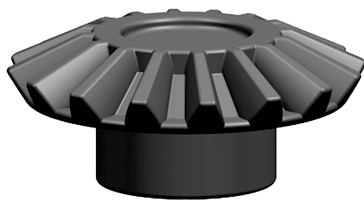
图 2 半轴齿轮 (锻压工序零件) 三维模型
