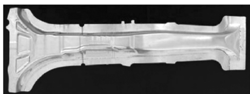
图 21 拼焊板热冲压 B 柱
