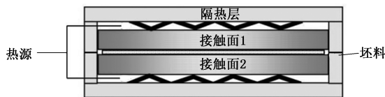
图 7 接触加热原理图
